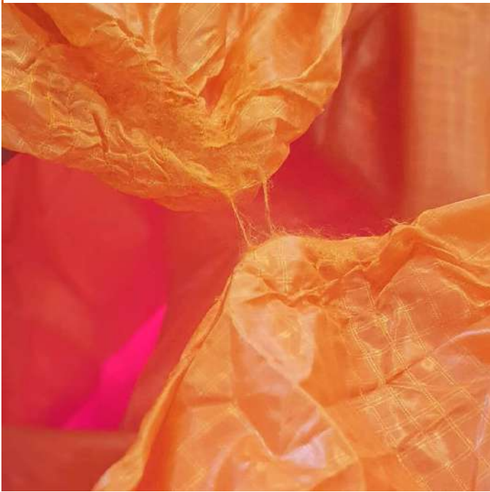
Fig. 4 Dommages causés par le velcro sur la calotte du secours
